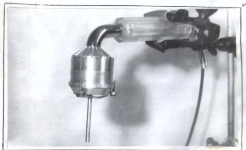
Фото 3. Жесткая (металлическая) ультразвуковая насадка.
