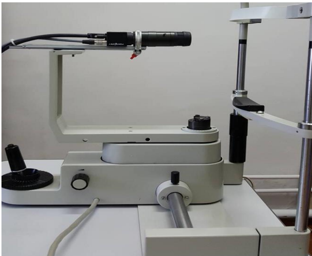
Рис. 2.2. Зовнішній вигляд пристрою для інфрачервоної діафаноскопії адаптованого до кріплення щілинної лампи.
