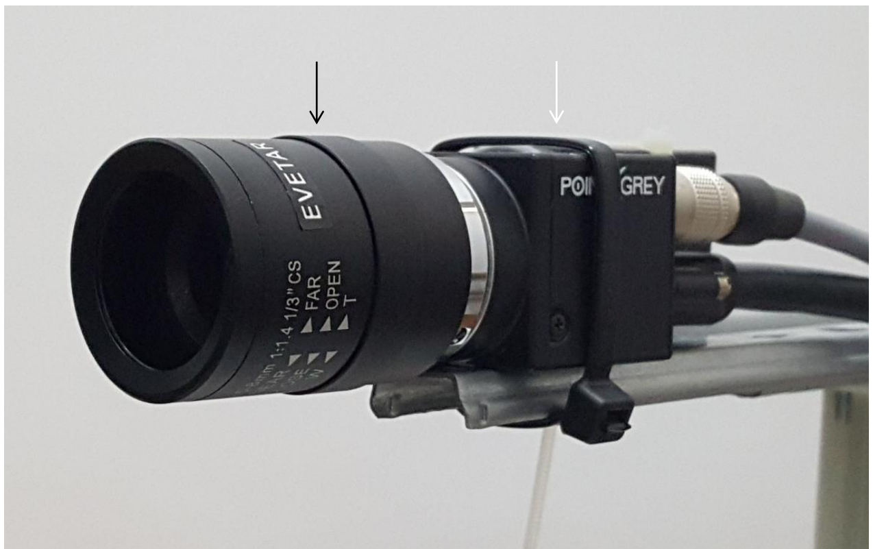
Рис. 2.1. Зовнішній вигляд монохромної відеокамери з можливістю реєстрації ближнього інфрачервоного сигналу для проведення інфрачервоної діафаноскопії, адаптованої на рухомій частині щілинної лампи (чорною стрілкою вказаний об'єктив, білою – відеокамера).
