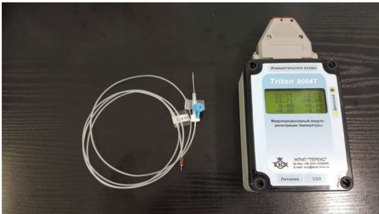
Рис. 2.1. Зовнішній вигляд термоелектричного пристрою для реєстрації температури і вимірювального зонда з термоелектричним датчиком температури
